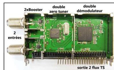
Figure 2 : le NIM tuner FTS4334L-V
