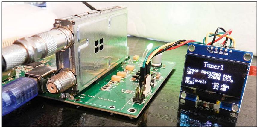
Figure 4 : partie droite du MiniTunerPro reliée à un Afficheur Oled 1,3 pouce
