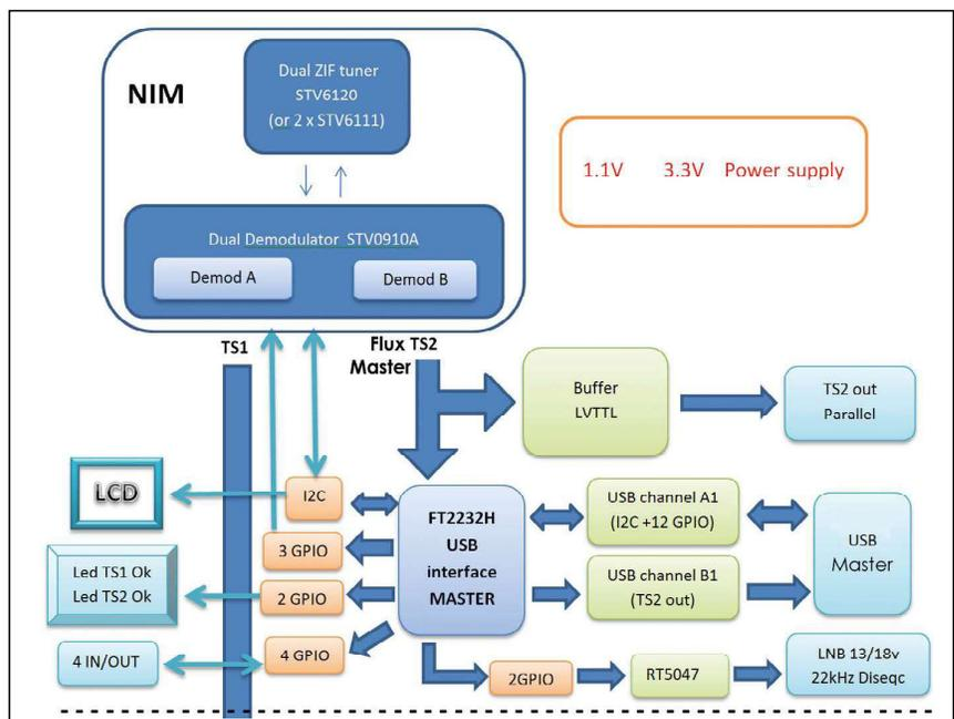
Figure 5 : utilisation de la partie Master du MiniTunerPro
