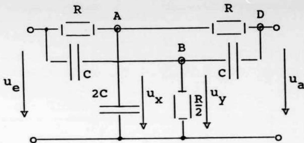
Bild 12: a) Kerbfilter (Notch) in der Form eines Doppel-T RC-Netzwerkes
