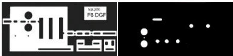
Le circuit imprimé: époxy double face de 76 mm. X 37 mm.
