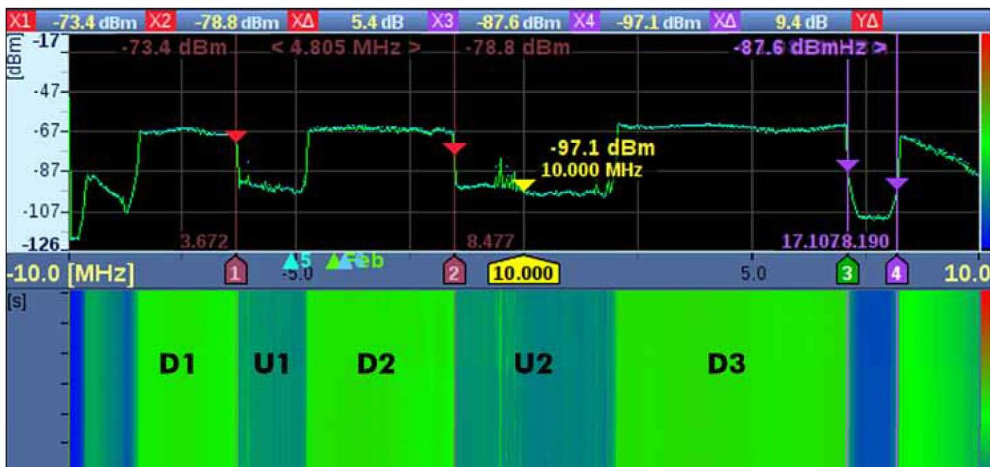
Figure 1: Spectre avec Upstreams U1 jusqu'à U2 et Downstreams D1 jusqu'à D3
