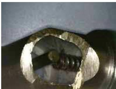
soupçonnons bien sûr les antennes. Le mât est redescendu et les antennes sont mesurées les unes après les autres: aucun résultat concluant. Le SWR fluctuait de manière erratique, synonyme d'un mauvais contact. Finalement après bien des essais, nous avons supprimé tous les adaptateurs coudés et tout est rentré dans l'ordre, comme par enchantement.
