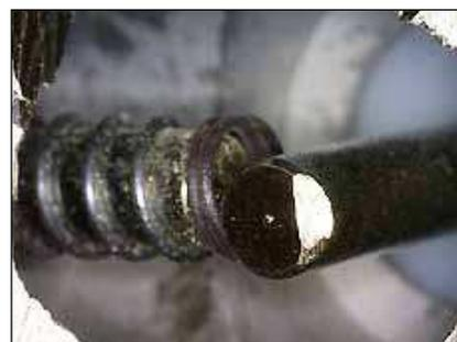
matériel en le faisant travailler relativement longtemps à une puissance importante. Le signe distinctif de ce connecteur de mauvaise qualité est une gomme d'isolation contre l'humidité de couleur orange, comme sur la photo ci-dessous.
