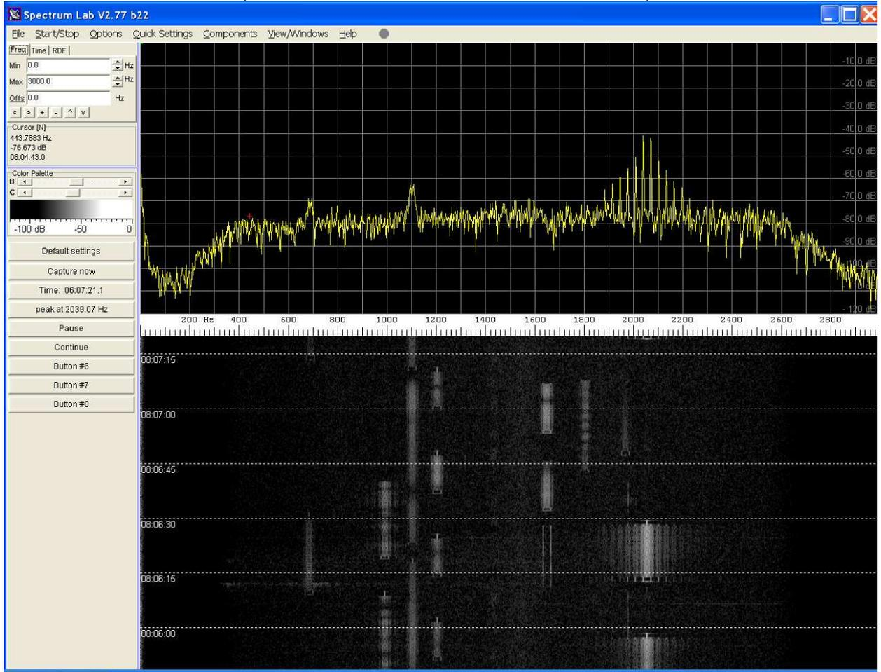
Le Tx régule et vient sur la fréquence du VFO, mais reste sur-modulé avec des bandes latérales inadmissibles.
