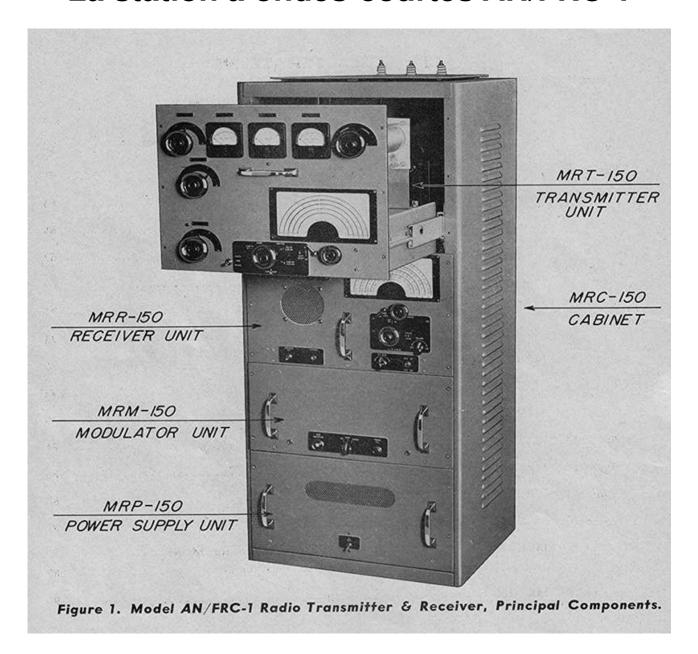
À Berlin\*, il y avait la station de radio à ondes courtes Radio Set Model AN/FRC-1 ou RT-16/FRC-1 avec un émetteur séparé MRT-150 + récepteur MRR-150, gammes de fréquences d'env. 1,5-12,5 MHz, puissance de sortie de l'émetteur d'environ 150 W, modes de fonctionnement télégraphie et téléphonie. Le trafic radio était en télégraphie (CW) avec la station radio EPD.
